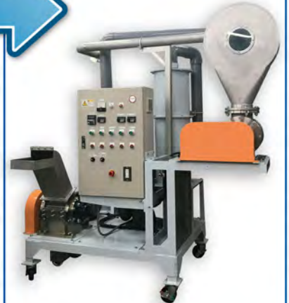
横型サイクロン サイクロンの性能はそのままに、本体高さを低くしました。前面窓(取外し可能)から内部の視認性を確保、配管を取り外す事無く清掃が可能です。(特許取得済)
